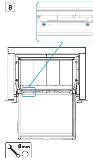
**Étape 9** Pour le 21-85, dévisser manuellement les vis tête ronde striée qui bloquent le passage des ajusteurs.
