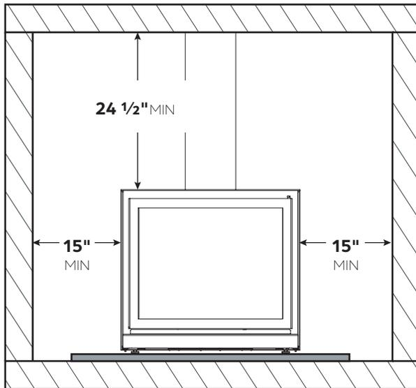
Lorsque le poêle est installé dans une alcôve, les dégagements latéraux minimaux sont augmentés pour permettre l'aération.
