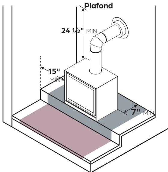
Lorsque la cheminée du poêle est installée au travers du mur, les dégagements latéraux minimaux sont augmentés pour permettre l'aération.
